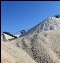
STOCKAGE A PLAT
